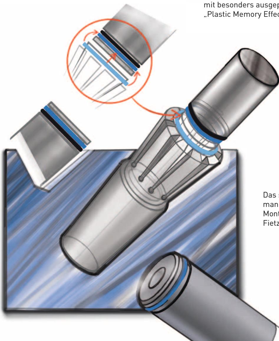
Das sichere Montageprinzip für die manuelle oder vollautomatische Montage mit den speziell abgestimmten Fietz-Montagewerkzeugen.
