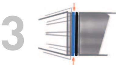
Nun den Stützring mit einer gleichmäßigen Bewegung auf die Welle schieben.
