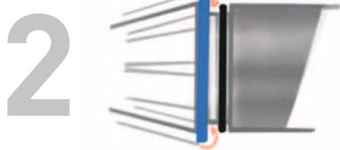
Montagehülse mit dem Fietz PTSM®-Ring an der Welle ansetzen und kontrollieren, dass dieser korrekt ausgerichtet ist. Hülse so positionieren, dass sie ansatzlos auf die Welle übergeht.
